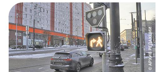
Под светофором теперь может быть расположена секция в виде силуэта пешехода и стрелки с мигающим сигналом бело-лунного цвета, указывающими, что за поворотом по направлению движения автомобиля есть переход, по которому сейчас могут идти пешеходы.
