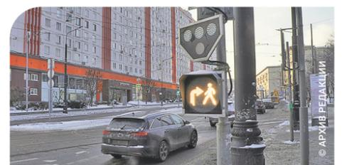
**Под светофором теперь может быть расположена секция в виде силуэта пешехода и стрелки с мигающим сигналом бело-лунного цвета, указывающих, что за поворотом по направлению движения автомобиля есть переход, по которому сейчас могут идти пешеходы.**
